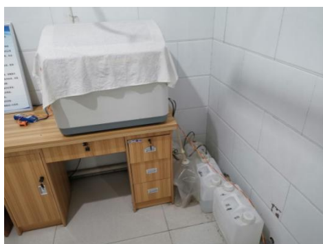
化验废水收集装置
